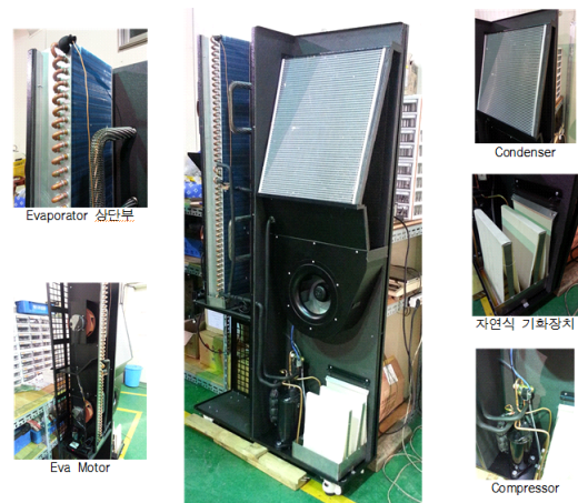
그림 6. 블록단위 공조시스템 제작품 Fig. 6. Prototype of Block Air Conditioning System
