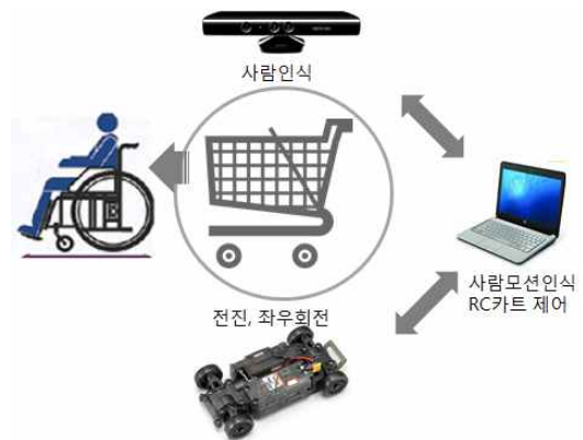
그림 3. 사용자지향 자율주행 쇼핑카트 구성도 Fig. 3. System configuration for user oriented autonomous shopping cart
