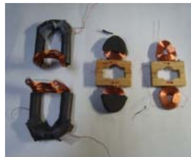
그림 3. 반코일, 삼각코일의 차폐 Fig. 3 The half- coil and shielding of the triangle coil
