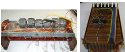
그림 8. SSC와 GC에 의한 강구의 가속 장치 및 여자 회로보드
