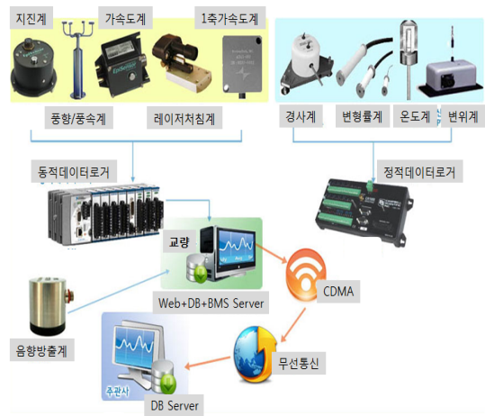
그림 1. 웹 기반 교량 모니터링 시스템 Fig. 1 Bridge Monitoring System based on Web
