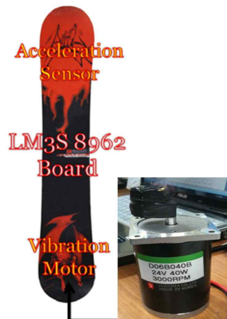
그림 5. 진동액추에이터와 스노우 보드 Fig. 5. Vibration Motor and Snowboard
