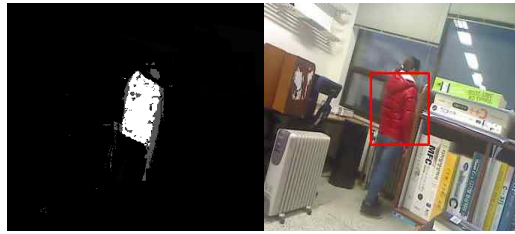
그림 6. PTZ카메라를 이용한 객체 추적 Fig. 6 Object tracking using PTZ camera
