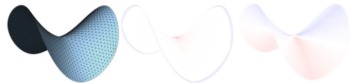
그림 3. 이산 곡률 추정 결과 (좌: 원본 모델, 중앙: 가우시안 곡률, 우: 평균 곡률) (파란색: 양의 곡률값, 빨간색: 음의 곡률값)
