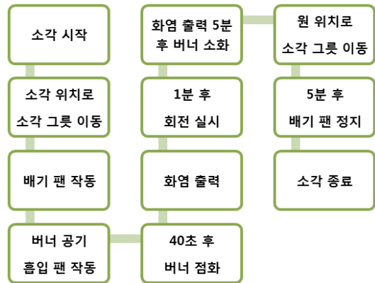
그림 3. 소각 처리 절차 Fig. 3. Incineration procedure
