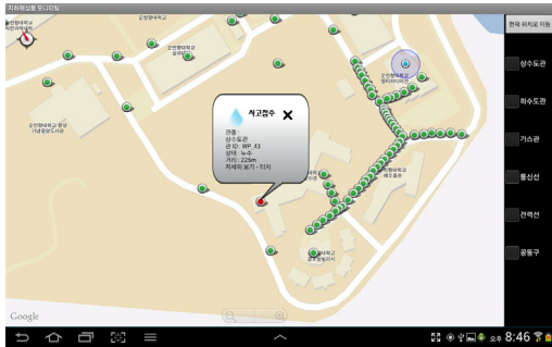
그림 11. 누수 상태의 마커(구글 맵 모드) Fig. 11. Leakage State of Marker(Google Map Mode)
