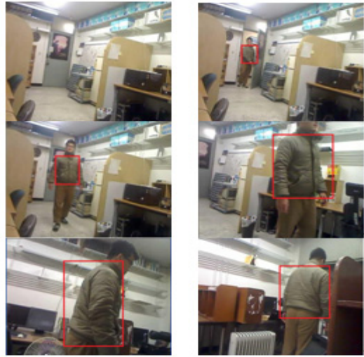
그림 7. PTZ카메라를 이용한 객체 추적 Fig. 7 Object tracking using PTZ camera
