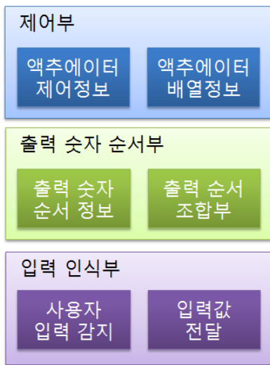
그림 7. 액추에이터를 활용한 패스워드 입력 모듈 구성 Fig. 7. The actuator consists of a password input module
