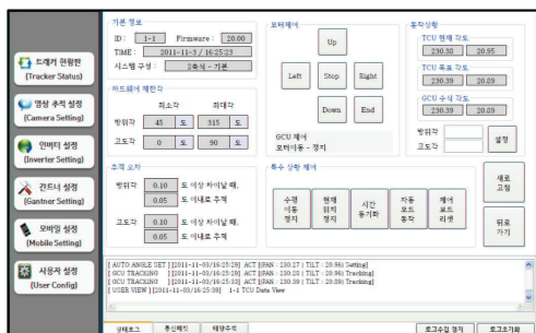
그림 7. 트래커의 상세 정보 및 수동 제어 Fig. 7 Detail information of Tracker and Manual Control
