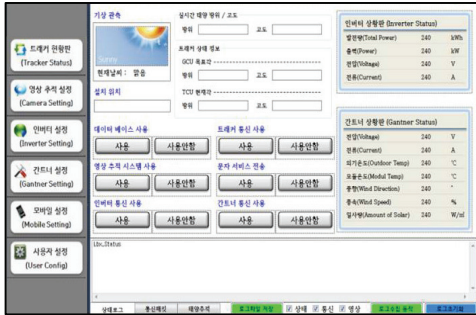
그림 6. 태양광 추적 모니터링 메인화면 Fig. 6. Capturing of the Main Solar Tracking
