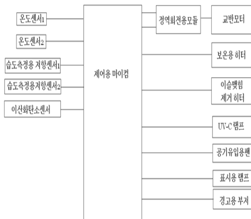
그림 2. 발효 소멸 장치 구성도 Figure 2. Fermentation-extinction system diagram
