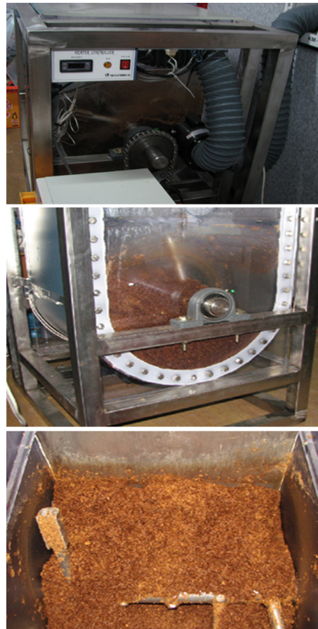
그림 4. 발효 소멸을 위한 교반 장치
