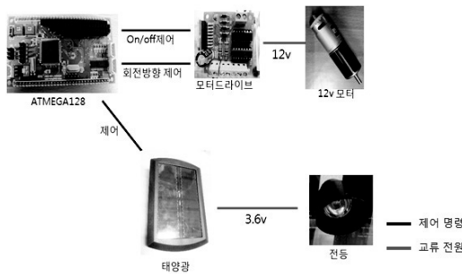
그림 6. 마이크로컨트롤러를 이용한 기기제어 Figure 6. control device using a microcontroller
