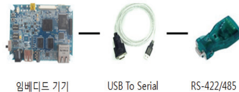
그림 5. USB To Serial 직렬 통신을 위한 연결 구성도 Figure 5. USB To Serial connection configuration for serial communications degree
