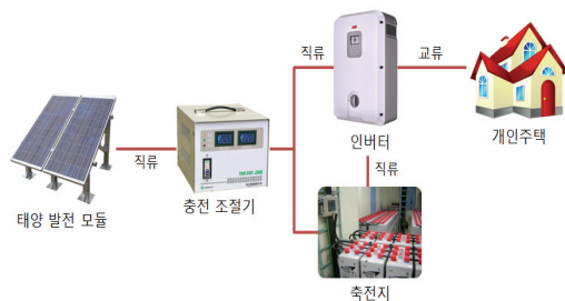
그림 1. 독립형 태양광 발전 시스템 Figure 1. Stand-alone Solar Power System
