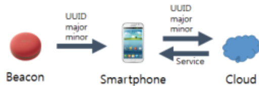
그림 1. 비콘 동작원리 Figure 1. Beacon Operating Principle
