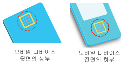
그림 6. 9개의 핀어레이 촉감모듈을 내장한 휴대용기기 Figure 6. Mobile device having 9 pin arrayed tactile module
