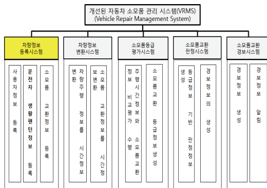
그림 4. 개선된 VRMS 구조도 Figure 4. Structure of Improved VRMS
