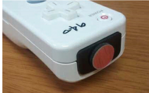
그림 2. 부착된 적외선 필터 Figure 2. Attached Infrared bandpass filter
