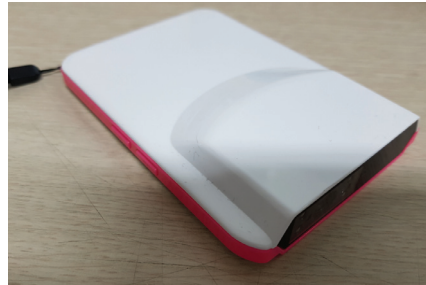
그림 2. 900MHz 대역의 RFID 리더기 Fig 2. 900MHz Band RFID Reader
