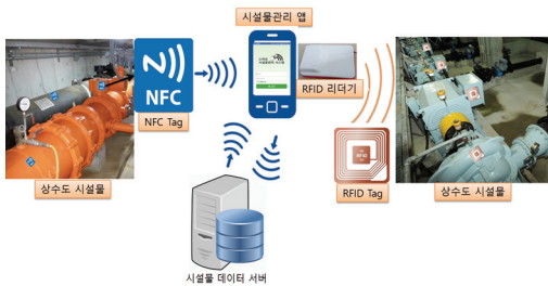
그림 3. 스마트 상수도시설물 자산관리 시스템 구조 Figure 3. Structure of Smart Waterworks Facility Asset Management System
