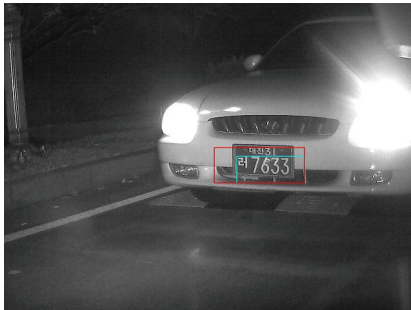
그림 12. 추출된 차량 후보 영역 Figure 12. Extracting candidate region of vehicle number
