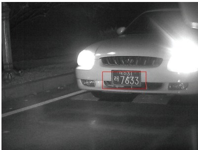
그림 13 차량 후보영역 추출 알고리즘 Figure 13. Extracting vehicle number area
