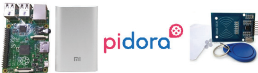
그림 4. 시스템 구성 부품(라즈베리 파이 3 모델 B/보조 배터리/피도라 리눅스/RFID 키트) Figure 4. System Components(Raspberry Pi 3 Mode B/ Battery/Pidora Linux/RFID Kit)
