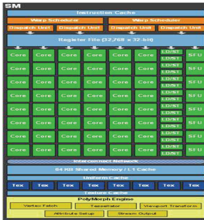
그림 3. 일반적인 GPU 코어 및 메모리 구조 Figure 3. General Structure of GPU Cores and Memory
