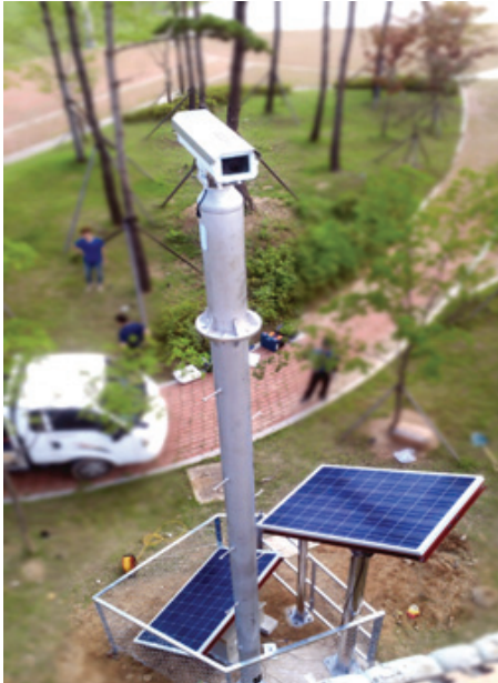
그림 6. 태양광 타임랩스 실험 장치 Figure 6. Timelapse Experimental Devices with Two Solar Panels
