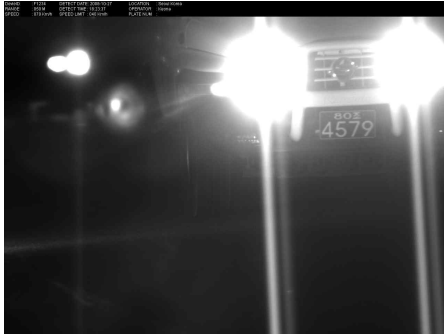
그림 2. 비정상 전조등 Figure 2. Abnormal Headlight for Night Vehicle Image
