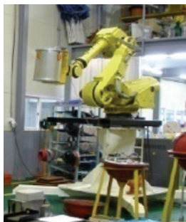
그림 3. 시뮬레이션 로봇의 파고 검교정 장치 Figure 3. Wave Height Calibration Device of Simulation Robot
