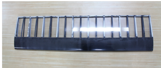
그림 11. 리브 9EA 추가 날개(341.1g) Figure 11. Wing added 9EA Ribs
