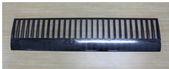
그림 12. 리브 18EA 추가 날개(501.6g) Figure 12. Wing added 18EA Ribs
