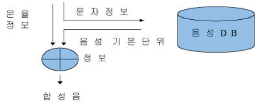
그림 3. 음성신호 처리 과정 흐름도 Figure 3. Speech Signal Transaction Process Flow
