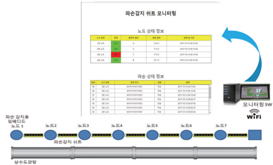
그림 8. 스마트시트 모니터링 시스템 서비스 Figure 8. Smart Sheet Monitoring System Service
