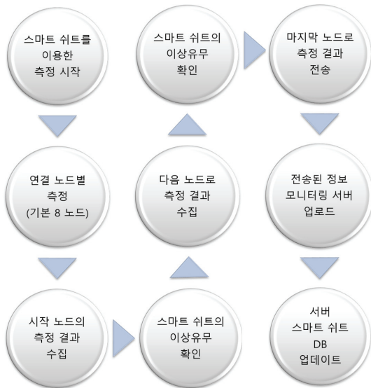
그림 6. 스마트시트 측정 과정 및 DB 업데이트 Figure 6. Smart Sheet Measurement Process and DB Update
