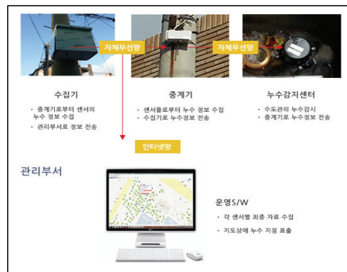
그림 1. 유량계 및 수압계를 이용한 모니터링 시스템 Figure 1. Monitoring System using Flow Meter and Water Pressure Meter
