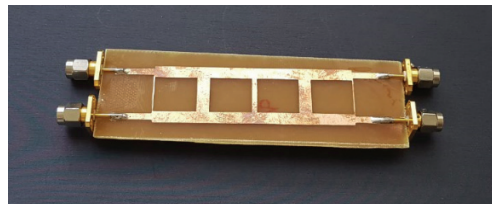
그림 3. 5단 브랜치라인 결합기의 제작 패턴 Figure 3. Fabricated pattern of the coupler with five-stage branch line
