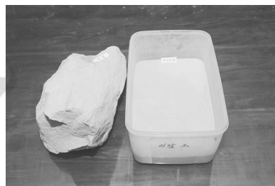
<寫眞-06> 埋沒材料(泥岩과 泥岩粉末)
