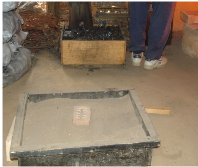
<그림 4-1> 고로에서 쇠를 녹임 <그림 4-2> 도토판에 쇳물을 부을 준비
