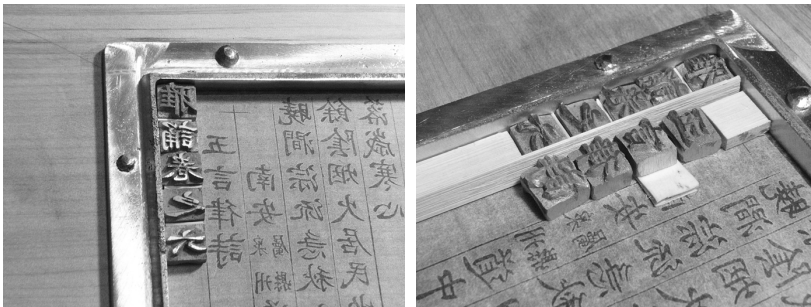
<사진 10> 「아송」의 조판 시작 모습 및 계선 채우기와 활자의 높이 조정
