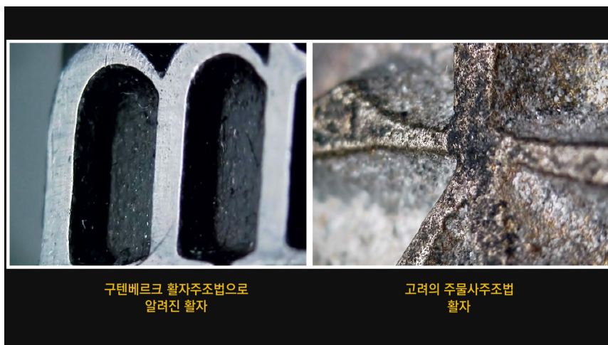
<그림 2-3> 종래 금속주형주조법으로 추정한 구텐베르크 활자(사진 左)와 證道歌字를 주물사주조법으로 복원·주조한 활자(사진 右)의 글자면 비교
