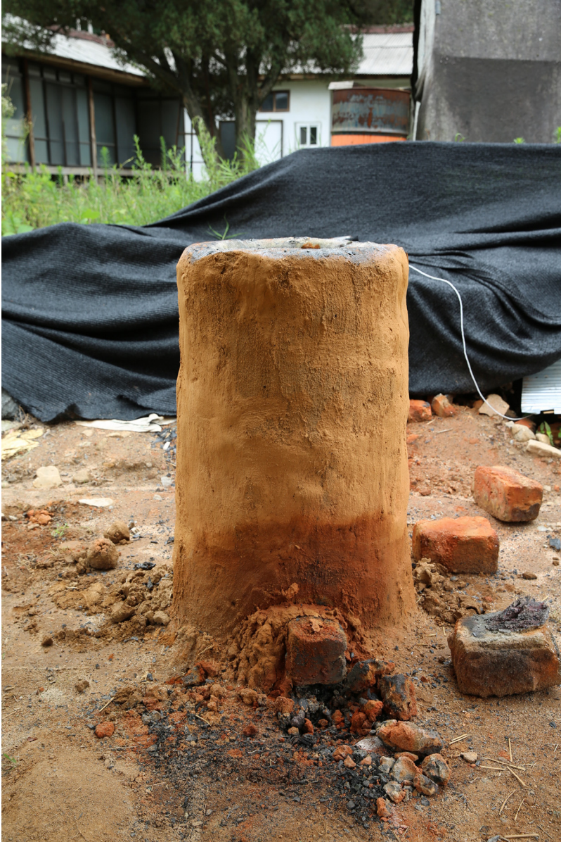
<그림 3> 축조 완료된 제련로 사진
