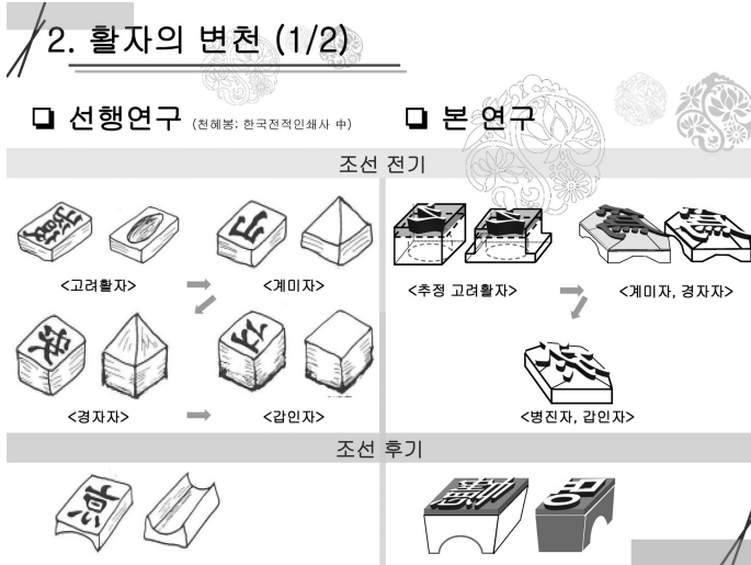
<그림 3> 고려활자, 조선 계미자·경자자 및 갑인자와 후기 활자 주조 형태의 변천
