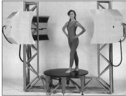
〈그림 1〉 Cyberware Laboratory Inc.의 Whole body 3D Scanner WB4
