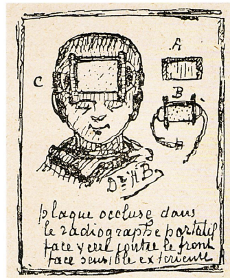
[도 8] 다르게와 바라뒤가 제작한 이동식 방사선 촬영 장치
