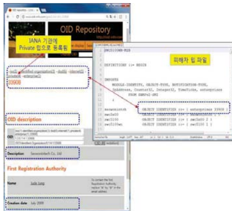
그림 2. IANA 기관에 사설(private) MIB으로 등록된 A사 MIB Fig. 2. Analysis of victims' MIB registered privately in IANA institution
