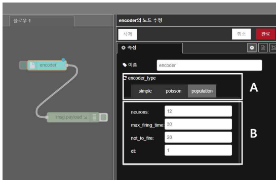
그림 8. NA-IDE 환경에서 구현한 인코더 컴포넌트 Fig. 8. Implemented encoder component on NA-IDE
