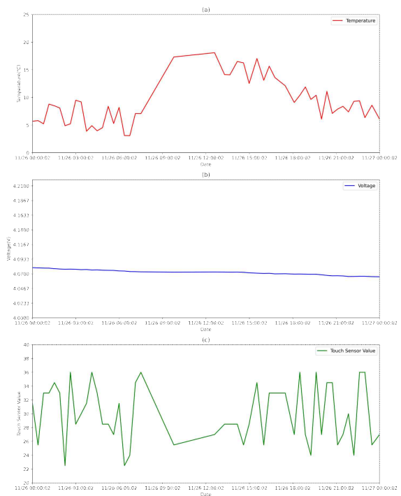
(a) : 온도 (b) : 배터리 전압 (c) : 정전용량 값 그림 5. 목걸이형 센서 수집 데이터 Fig. 5. Necklace Type Sensor Collection Data
