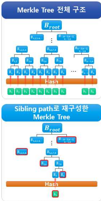
그림 3. Sibling path를 이용한 Merkle Tree 재구성 Figure 3. Merkle Tree reconstruction using Sibling Path
