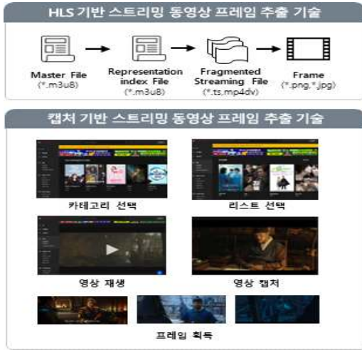
그림 2. HLS 기반 및 캡처 기반 스트리밍 프레임 추출 방법 Fig. 2. HLS-based and capture-based Streaming frame extraction methods
