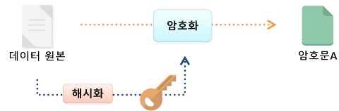
그림 3. Convergent Encryption의 개요 Fig 3. Overview of Convergent Encryption
