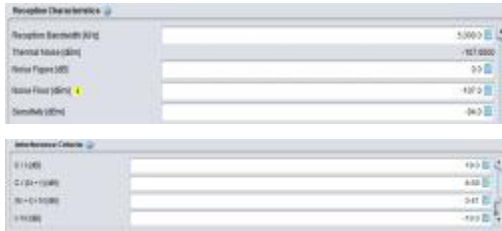
그림 7. 희생링크 수신기 수신 특성 및 간섭 기준 설정 Fig. 7. Setting Receiver Characteristics and Interference Criteria for the Victim Link Receiver
