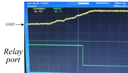
(b) (+) 직류 인가 시 (Ch1 : 500mV/DIV, Ch2 : 2V/DIV)
