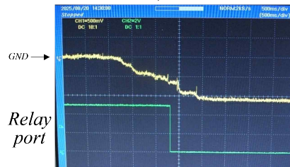
(c) (-) 직류 인가 시 (Ch1 : 500mV/DIV, Ch2 : 2V/DIV) 그림 10. 출력 직류 검출 실험 결과 Fig. 10. Result of detecting DC output
