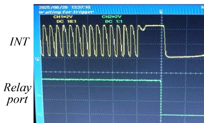
그림 11. 교류 차단 검출 실험 결과 (Ch1 : 2V/DIV, Ch2 : 2V/DIV)
