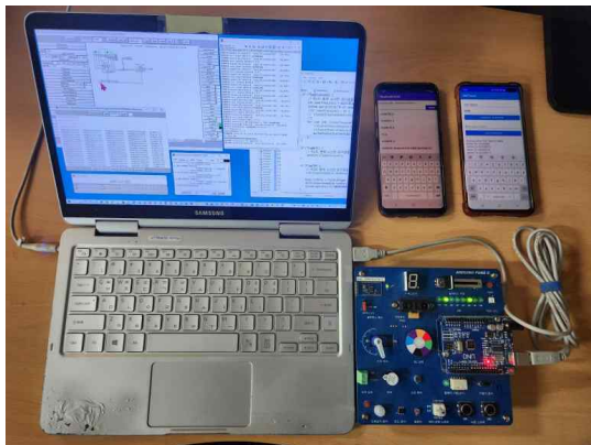
그림 2. 마이크로컨트롤러 데이터 송신 검증 Fig. 2. Microcontroller Tx data verification
