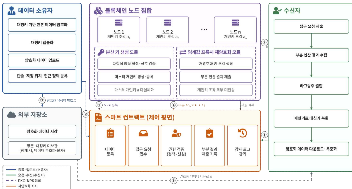
그림 1. 제안 시스템 구성도 Fig. 1. Proposed System Architecture
