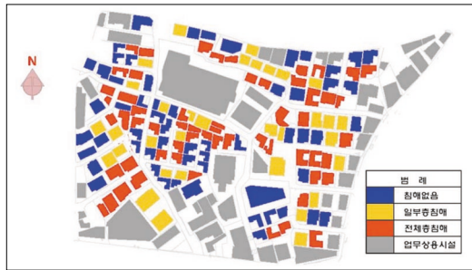
재개발 전 기존 건축물에 의한 일조영향 건축물
