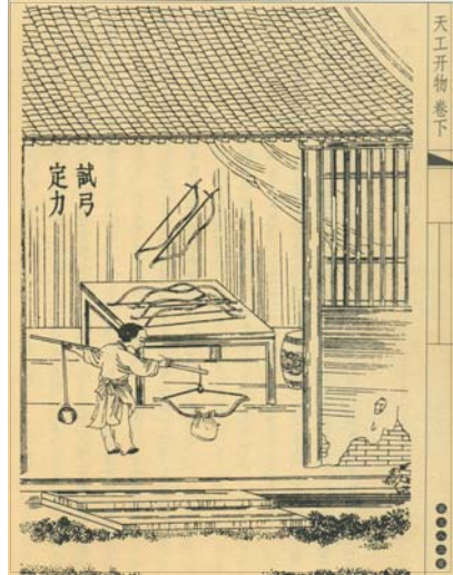
〔그림 1〕 활의 張力을 재는 방법. 《天工開物》
